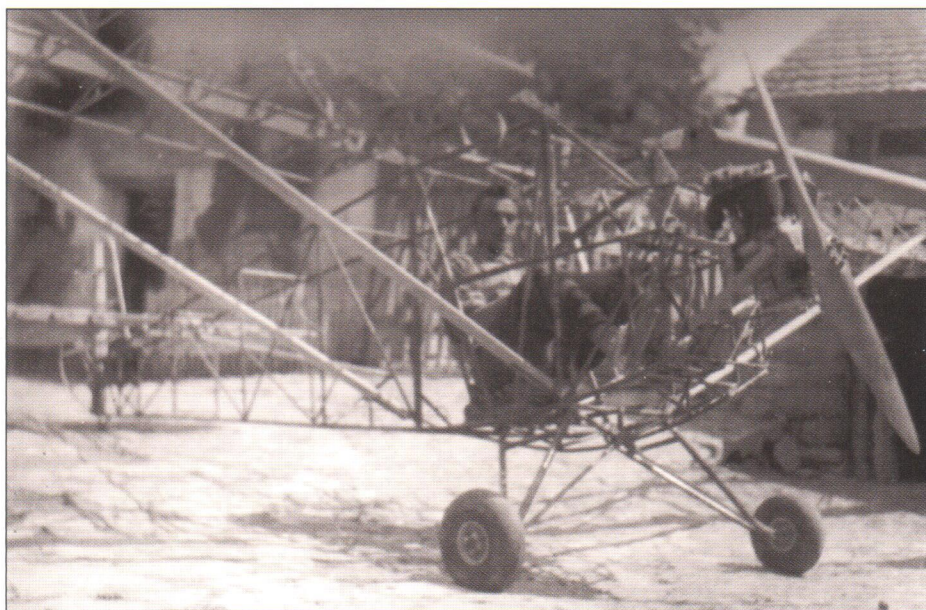
Kompletně sestavená kostra letadla s kovovým trupem a dřevěnou konstrukcí křídla
